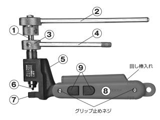
(1) 中心ネジ………… 先端に抜きピンがあり、ピンは左ネジ込み式
