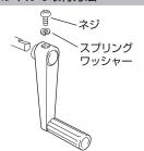
付属のハンドルをネジとスプリングワッシャーを使用して 図のように取り付けてください。
