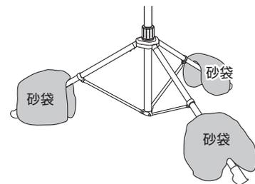
三脚スタンドを設置する場合、安定の良い平坦な場所に垂直に設置してください。風の強い場合は転倒防止の為、下部に砂袋などで倒れ止めの処置を必ず行ってください。
