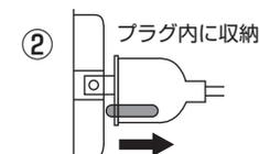
2Pコンセントに挿し込むと同時にアースピンがプラグ内に収納されます。(コンセントから抜くと自動的にアースピンはロックされます)
