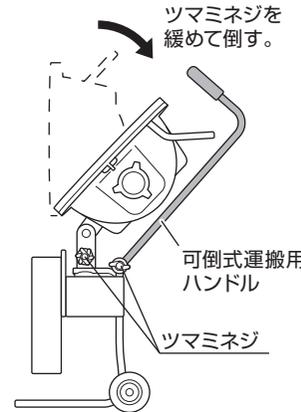
可倒式運搬用ハンドルを倒すと、灯体をスタンドに取り付けた状態で、上下の照光角度調節ができます。またスタンドから灯体を取り外せば、バイス取り付け型としてご使用いただけます。
