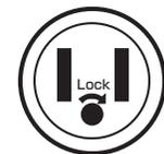
矢印方向に回してアースピンをロック。逆方向に回してロック解除。
