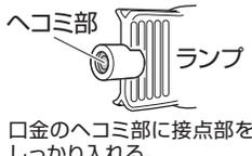
新しいランプを取り付けたら、ソケットの接点部にランプの口金が確実に取り付けられていることを確認してください。
