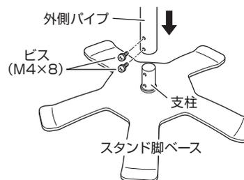
スタンド脚ベースの支柱に外側パイプをいっばいまで差し込み、支柱と外側パイプのビス穴を合わせて、付属のビスで締め付けてください。
