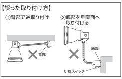
垂直面や逆取り付けの場合はマグネットの取り付 け方向に注意して鉄板厚ができるだけ厚い構造 物に取り付けて使用すること。(板厚10mm以上 で最大吸着力が得られます)薄板はマグネット の吸着力が弱く落下事故 の原因となります。
