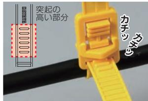
電線など細径の結束物の場合は固定孔(C)にベルトを入れ、結束物の径に合わせて突起の高い部分(D)まで締め付けると、バンド本体を結束物に取り付けることができます。
