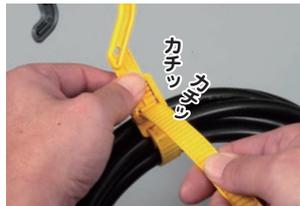
ベルトを固定孔(B)に入れてカチッカチッと締め付け結束します。ストッパー(A)を押してベルトを引っ張ると、締め付けの調整ができます。
