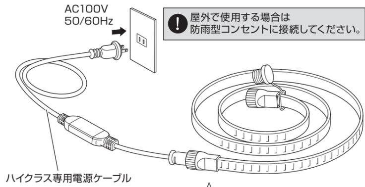
LEDテープライトにハイクラス専用電源ケーブルをしっかりと取り付け、コンセントにプラグを確実に挿し込んでください。
