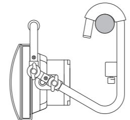
吊り下げる単管パイプまたは重量に耐えられる構造物に取り付けてください。
