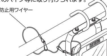
吊り下げて使用する時は落下しないよう付属の落下防止用ワイヤーで落下防止の処置を行ってください。
