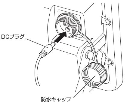
**2** ACアダプターをコンセントに接続してください。充電が開始されるとインジケーターが点滅し全て点灯すると充電完了です。
