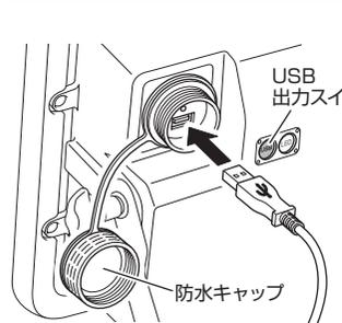
灯体背面左側の防水キャップを外し、USB出力スイッチを押してから、USBポートにUSB端子を挿し込んでください。バッテリー残量インジケータで電池残量が確認できます。
