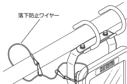
吊り下げフックはφ50(φ48.6単管パイプに適合)までのパイプ等に取り付けられます。
