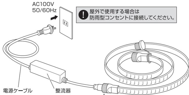
LEDテープライトに電源ケーブルをしっかりと取り付けコンセントにプラグを確実に挿し込んでください。
