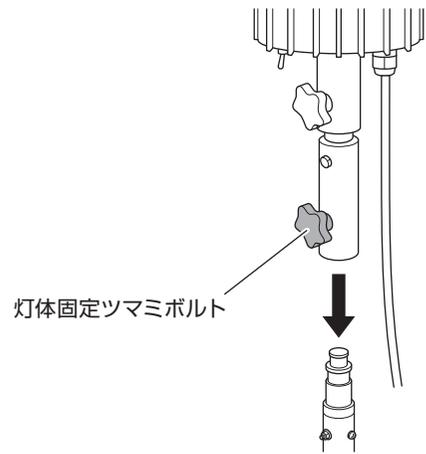
三脚の灯体接続部に灯体を挿し込み
