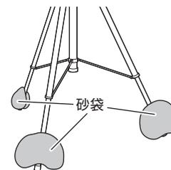
三脚スタンドを設置する場合、安定の良い平坦な場所に**垂直に設置**してください。風の強い場合は転倒防止の為、下部に砂袋などで倒れ止めの処置を必ず行ってください。
