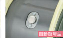
巻いたまま長時間使用したり、定格電流を超えて使用すると起こる電線の異常な温度上昇を感じ、コンセントへの給電をストップします。
