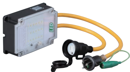
①照明点灯中 照明器具と電源元との間にLED補助灯を接続します ②給電がストップ! 照明点灯中に停電や発電機の燃料切れで給電がストップ! ③LED補助灯が点灯! 内蔵バッテリーにより補助灯が瞬時に点灯、復旧までの臨時照明として使用できます
