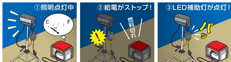
①照明点灯中 照明器具と電源元との間にLED補助灯を接続します ②給電がストップ! 照明点灯中に停電や発電機の燃料切れで給電がストップ! ③LED補助灯が点灯! 内蔵バッテリーにより補助灯が瞬時に点灯、復旧までの臨時照明として使用できます
