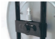
一次側接続部
