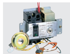
メタルセンサー感度調整式 (MSB-301KVX他) 漏電地絡保護専用型 定格／2P 100V 30A 漏電感度電流／15mA 高速形／衝撃波不動作形
