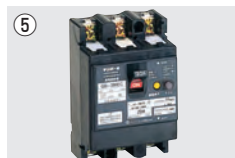
GB-3MEC(BL-302M他) 漏電過負荷短絡保護兼用型 定格／3P 100/200V兼用 20A 漏電感度電流／30mA 高速形／衝撃波不動作形
