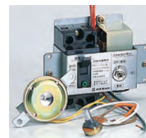
●大型コアドリル対応 メタルセンサー (金属感知機能)
