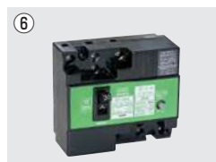
GT-31EA(BR-302M他) 漏電地絡保護専用型 定格／3P 220V 30A 漏電感度電流／30mA 高速形／衝撃波不動作形
