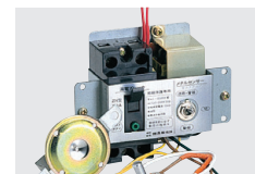
メタルセンサー感度調整式 (MSB-301KVX他) 漏電地絡保護専用型 定格／2P 100V 30A 漏電感度電流／15mA 高速形／衝撃波不動作形
