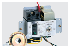
メタルセンサー (MSB-301KX他) 漏電地絡保護専用型 定格／2P 100V 30A 漏電感度電流／15mA 高速形／衝撃波不動作形
