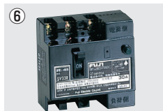
SV-33R (BR-302M他) 漏電地絡保護専用型 定格／3P 100/200V兼用 30A 漏電感度電流／30mA 高速形／衝撃波不動作形
