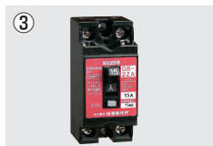
GB-2ZA (BG-301KX他) 漏電過負荷短絡保護兼用型 定格／2P 100/200V兼用 15A 漏電感度電流／15mA 高速形／衝撃波不動作形
