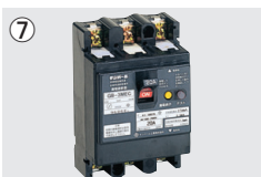
GB-3MEC (SBLE-232M他) 漏電過負荷短絡保護兼用型 定格／3P 100/200V兼用 20A 漏電感度電流／15mA 高速形／衝撃波不動作形
