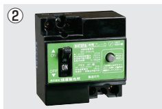
BS-23015 (BS-301K他) 漏電地絡保護専用型 定格／2P 100/200V兼用 30A 漏電感度電流／15mA 高速形／衝撃波不動作形
