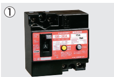
GB-2EA, BJJ (BR-301他) 漏電過負荷短絡保護兼用型 定格／2P 100/200V兼用 15A 漏電感度電流／15mA 高速形／衝撃波不動作形
