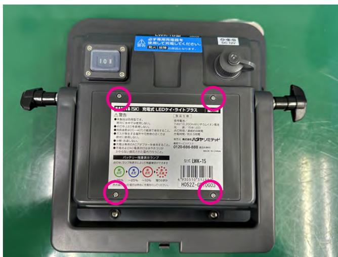
本体背面のネジ(4ヶ所)を外し、バッテリーカバーを取り外します。
