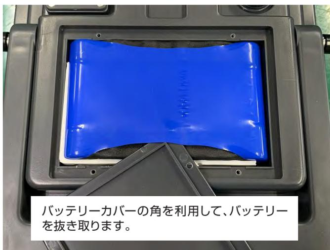
バッテリーカバーの角を利用して、バッテリーを抜き取ります。
