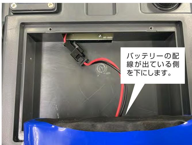
バッテリーの配線が出ている箇所を下にして黒色のコネクタと配線をケース内に収めながらバッテリーを取り付けます。
