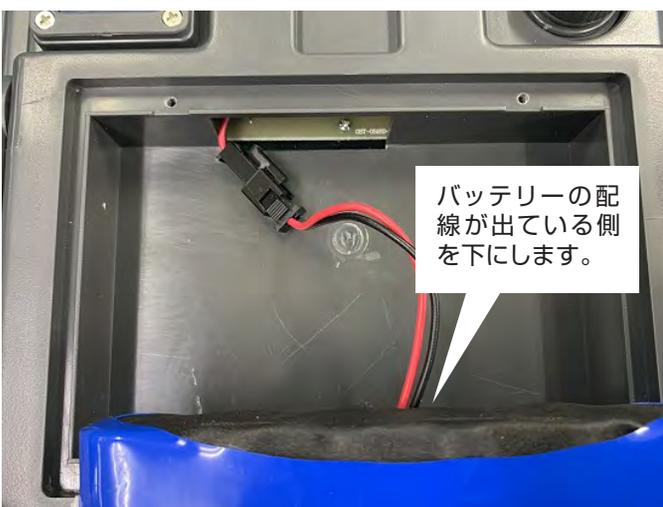
バッテリーの配線が出ている箇所を下にして黒色のコネクタと配線をケース内に収めながらバッテリーを取り付けます。
